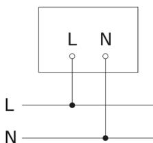
Schema elettrico Master-Master collegamento in rete
